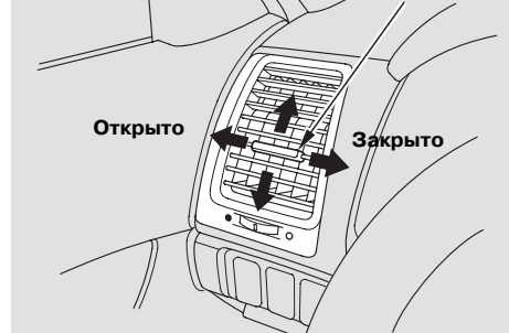
БОКОВАЯ ВЕНТИЛЯЦИОННАЯ РЕШЕТКА ВОДИТЕЛЯ РЫЧАЖОК ДЕФЛЕКТОРА
